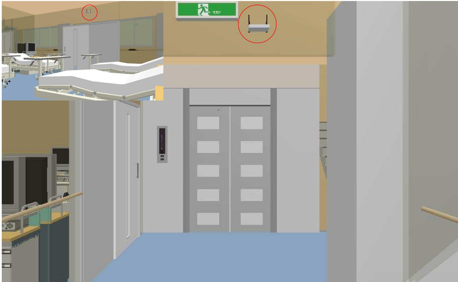
各階への接続は、配管がない場合など、階段のスペースを利用して各階へ有線にて接続します。
